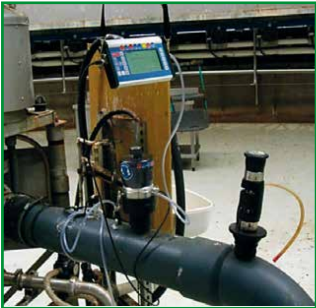
Abb. 4.2.1.: Vakuum- und Luftmessung im Melkkrussell
