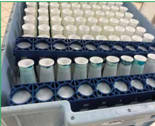
**Abb. 1: MLP-Kasten mit falsch einsortierten Racks**
