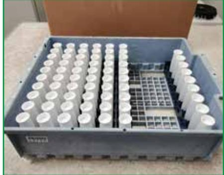
Abb. 3: Unvollständig gefüllter Probekasten mit einem Rack leerer MLP-Flaschen als Stütze
